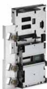
**VLT MCF 106, плата-адаптер для установки устройств под разъемы А/В в разъем С**
